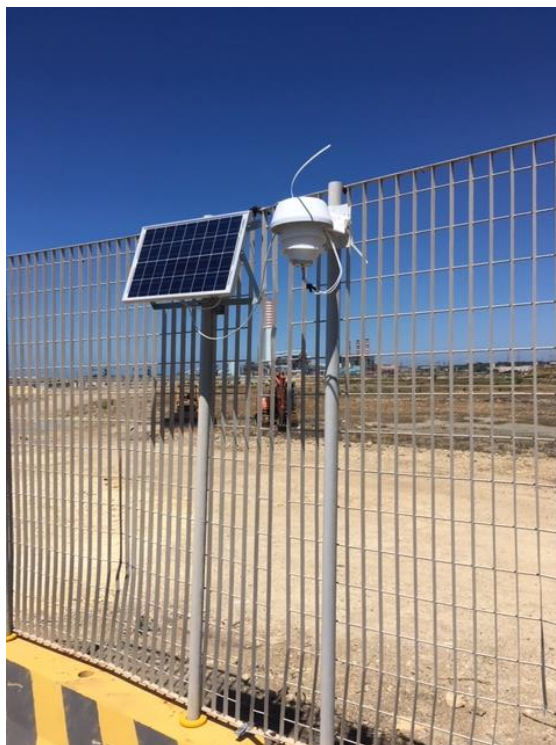
Figura 6: Campionatore a basso flusso installato nella zona portuale di Civitavecchia.
